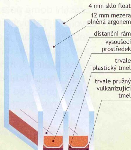
Okno Langer Zelená úsporám je vyráběno v maximálním rozměru 78/140 z důvodu větší hmotnosti izolačního trojskla. Větší rozměry oken je možné provést pouze ve variantě okna Langer Arktis.
